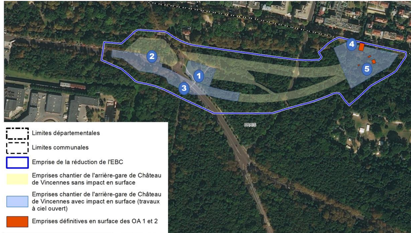
Figure 10 : Vue aérienne du couvert végétal des emprises du prolongement de la Ligne 1 et localisation des photos présentées ci-après : 1. Base vie ; 2 : raccordement sud ; 3 : Raccordement Sud ; 4 : Poste de redressement (OA 1) ; 5 : grilles et trappes de l'OA 2 (source : IDFM)
