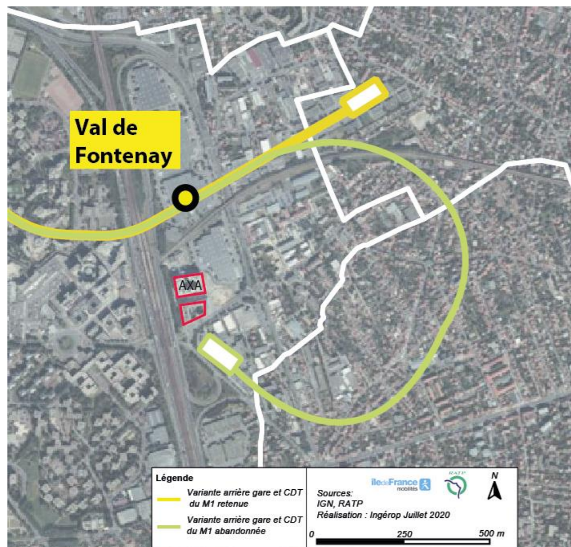
Figure 49 – Représentation des variantes de tracé en arrière-gare et de l'implantation du CDT (source : INGEROP)
