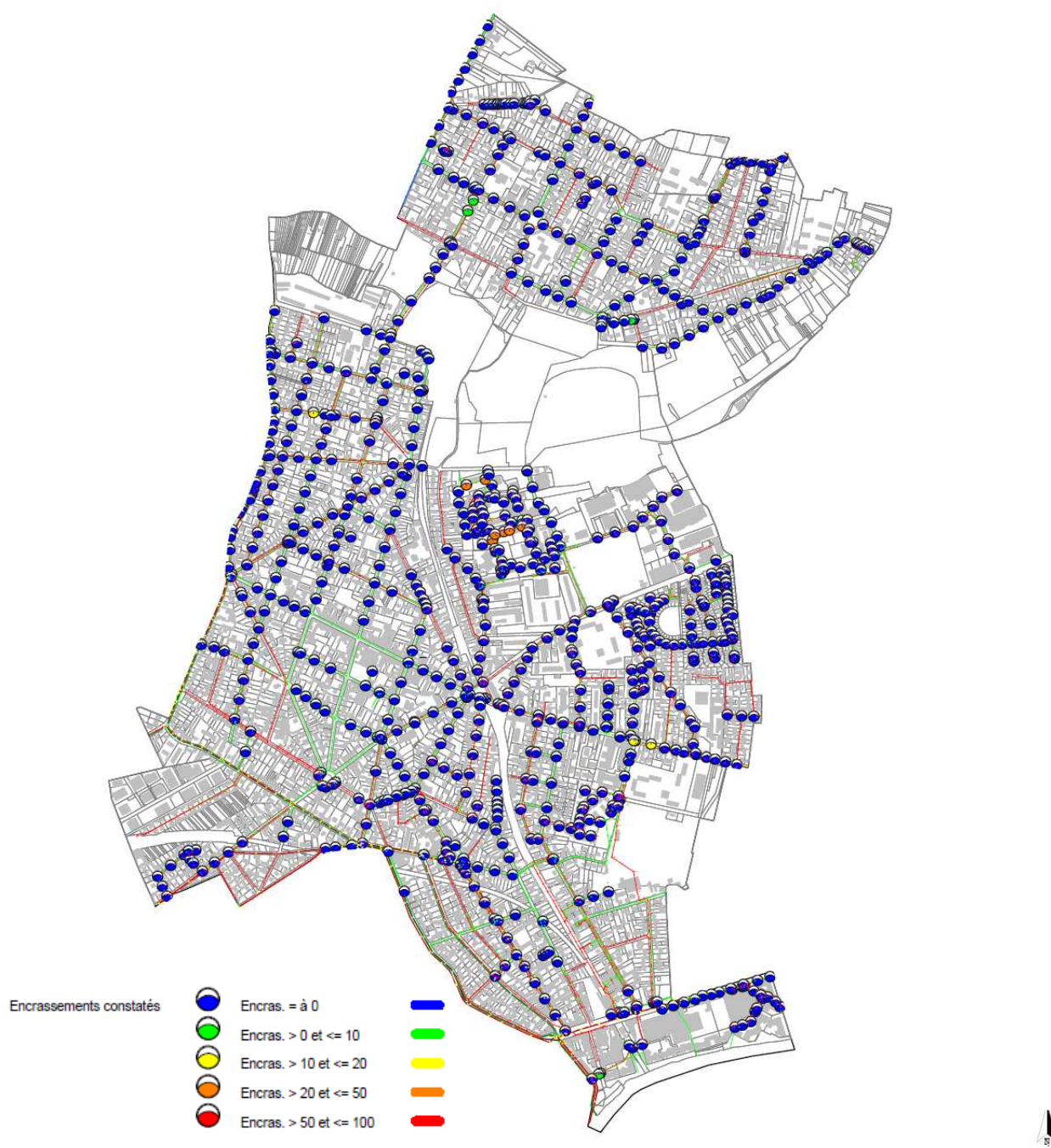
Carte du taux d'encrassement sur le réseau d'eaux pluviales
